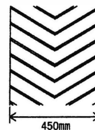
☆ 中寄せベルト 傾斜角度 25°
